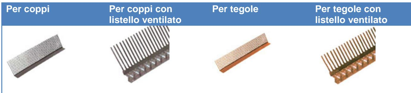
Il pettine parapasseri è una griglia di protezione contro l'accesso e la nidificazione di uccelli e piccoli animali sotto le tegole o i coppi; consente di **evitare rovinose conseguenze alle coperture**, eliminando così gli onerosi interventi di manutenzione. Permette inoltre la micro-ventilazione del sottomanto. I pettini parapasseri sono prodotti in acciaio zincato preverniciato di colore testa di moro e in rame.
