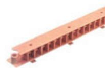
Il pettine parapasseri è un elemento di protezione contro l'accesso e la nidificazione di uccelli e piccoli animali sotto le tegole o i coppi; consente di evitare rovinose conseguenze alle coperture, eliminando così gli onerosi interventi di manutenzione. Permette inoltre una **micro-ventilazione del sottomanto**. I pettini parapasseri in plastica sono prodotti in polipropilene resistente ai raggi UV di colore nero o rosso cotto per permetterne una migliore integrazione con la copertura.
